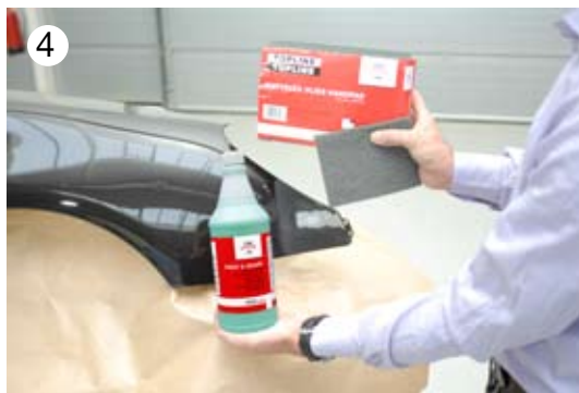
→ Mattieren der Randzone mit Prep & Scuff und Mattflex Grau oder Gold ( Achtung , Schutzhandschuhe tragen)
