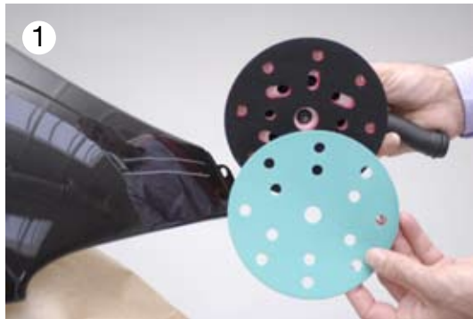
→ Ausschleifen des Kratzers mit P 240
