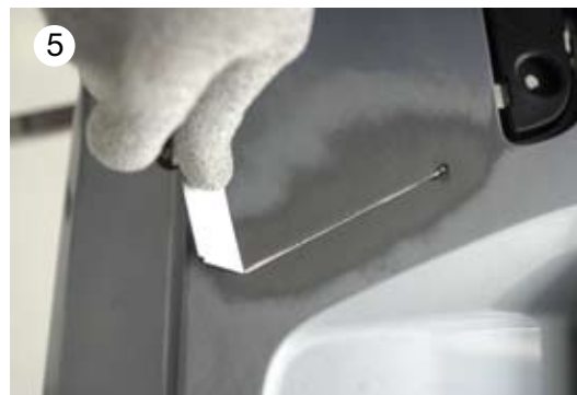
→ Mit dem Kuttermesser die zu reparierenden Stellen ausarbeiten (V-Kerbe)
