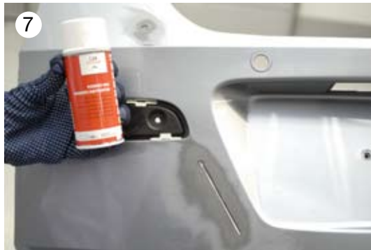
→ Auftrag des Primers/Aktivators von vorn und hinten
