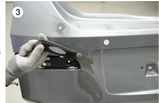
→ Vorbereiten der Schadstelle
