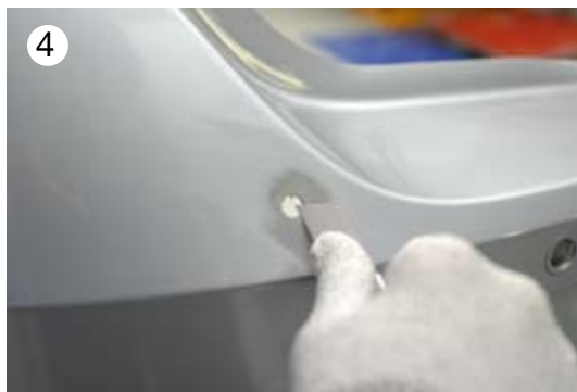
→ Mit dem Kuttermesser die zu reparierenden Stellen ausarbeiten (V-Kerbe)
