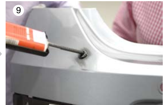
→ Aufbringen des Power Mix 2K - Klebers auf die Schadstelle von vorn und hinten
