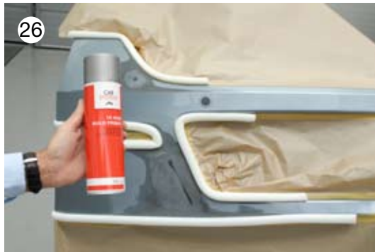
→ Füllern mit 1K High-Build Primer oder 2K VOC 541
