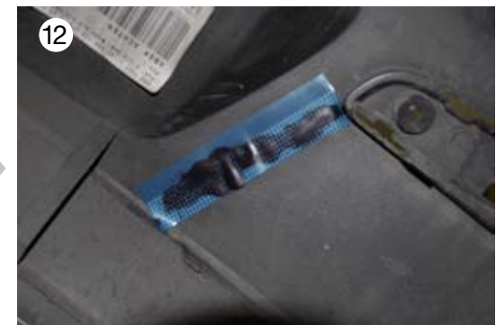
→ Aufbringen des Power Mix 2K - Klebers auf die Schadstelle von vorn und hinten
